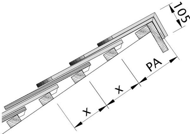
Disegno KLASSIK modello di tetto a una falda PDA
