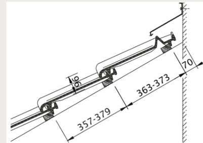
Wandanschluss (oben) mit Firstanschluss-Lüfterziegel
