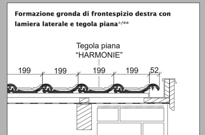
\* Il disegno tecnico rappresentato è solo un esempio di progettazione.
